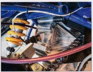
Ovan: Aprilia RS 125. Anders har konverterat hojen till eldrift. 20 kilo lättare än originalet. Topphastighet 122 kilometer i timmen. Räckvidd cirka 80 kilometer. Nedan: I mitten av bilden syns själva elmotorn. Dess drivaxel är helt i linje med svingarmens infästning i ramen. Lätt att mäta in kedjeslacket. Stötdämpare från Ohlins.
