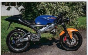
Ovan: Aprilia RS 125. Anders har konverterat hojen till eldrift. 20 kilo lättare än originalet. Topphastighet 122 kilometer i timmen. Räckvidd cirka 80 kilometer. Nedan: I mitten av bilden syns själva elmotorn. Dess drivaxel är helt i linje med svingarmens infästning i ramen. Lätt att mäta in kedjeslacket. Stötdämpare från Ohlins.
