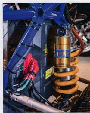
Controller-enheten hittas framför batteripaketet.
